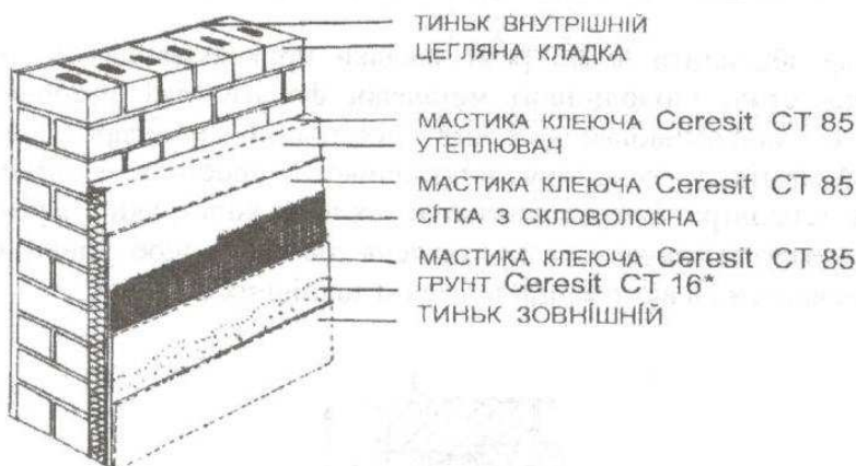
Рис. 7.3. Зовнішня стіна з ефективним утеплювачем
