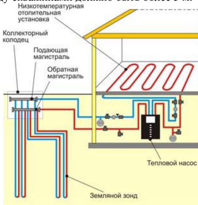
Рис. 7. Схема расположения земляного зонда
