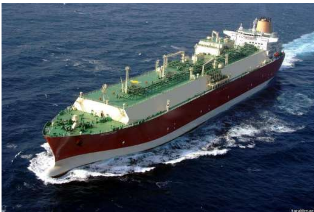
Рис. 5.11. ЗПГ-танкер Gaz Transport & Technigaz типу «Membrane» (мембранный резервуар)
