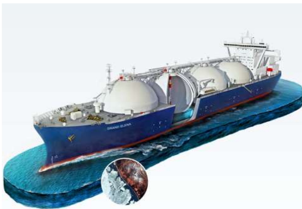
Рис. 5.10. ЗПГ-танкер типа «Moss» (сферичный резервуар)
